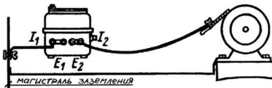
Рисунок 6 - Измерение сопротивления заземляющей проводки измерителем МС-08 при малых расстояниях между заземленными элементами и магистралью
